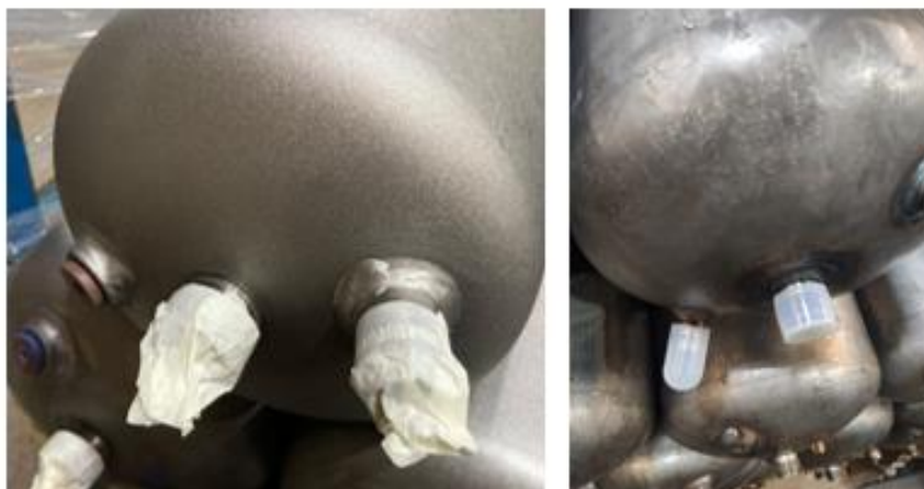
Figura 20 – Isolamento das conexões do reservatório – Antes x Depois Pintura
