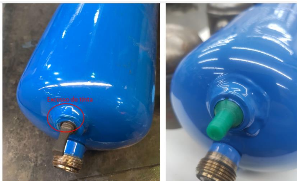
Figura 21 – Isolamento das conexões do reservatório – Pintura
