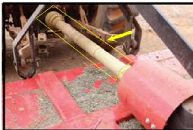
Figura 2 - Exemplo de tomada de potência com a proteção
