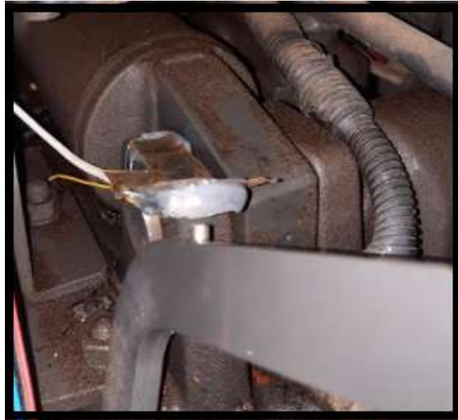
Figura 32 – Localização do Sensor de Detecção do freio de estacionamento
