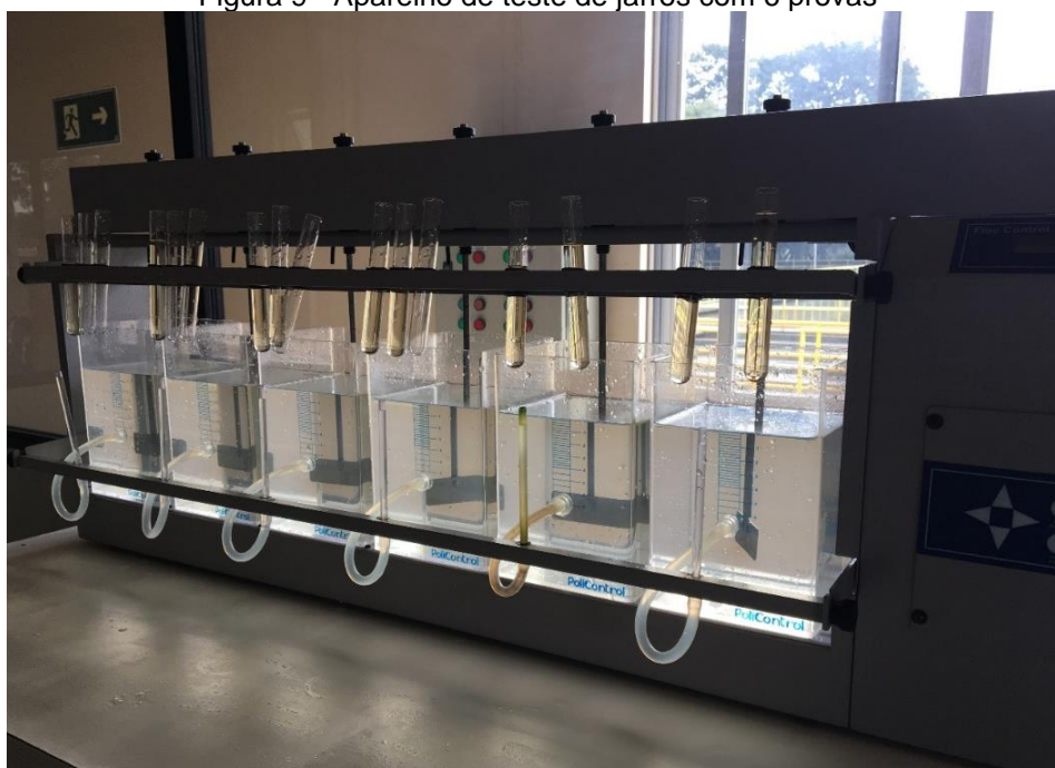
Figura 9 - Aparelho de teste de jarros com 6 provas
