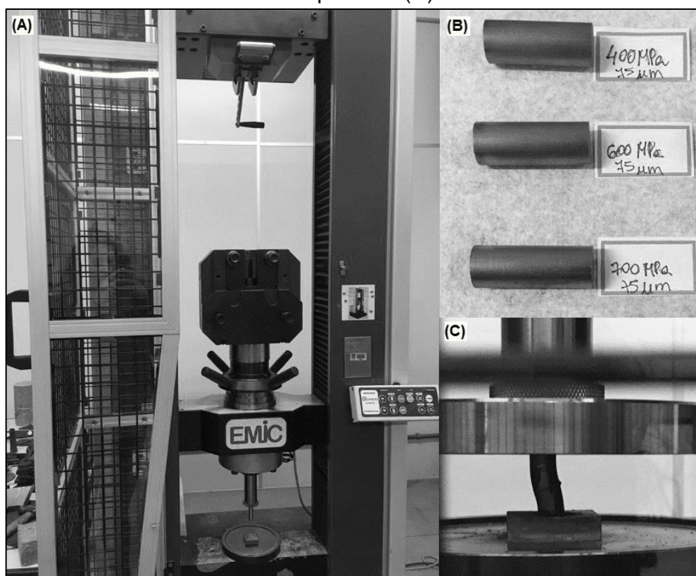
Figura 29 – Máquina Emic DL2000 (A), amostras para compressão (B) e ensaio de compressão (C)
