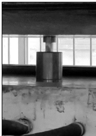
Figura 26 – Compactação do bloco no conjunto matriz-punções fabricado
