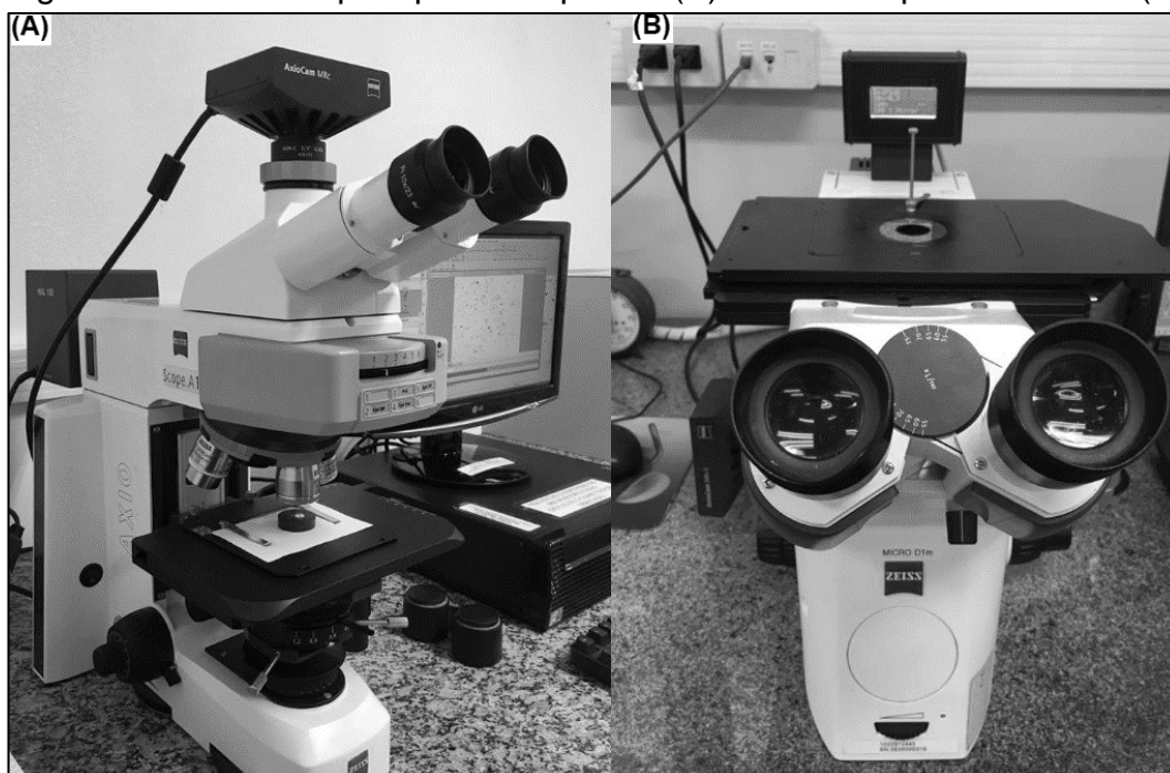
Figura 27 – Microscópio óptico Scope A.1 (A) e microscópio Micro D1m (B)
