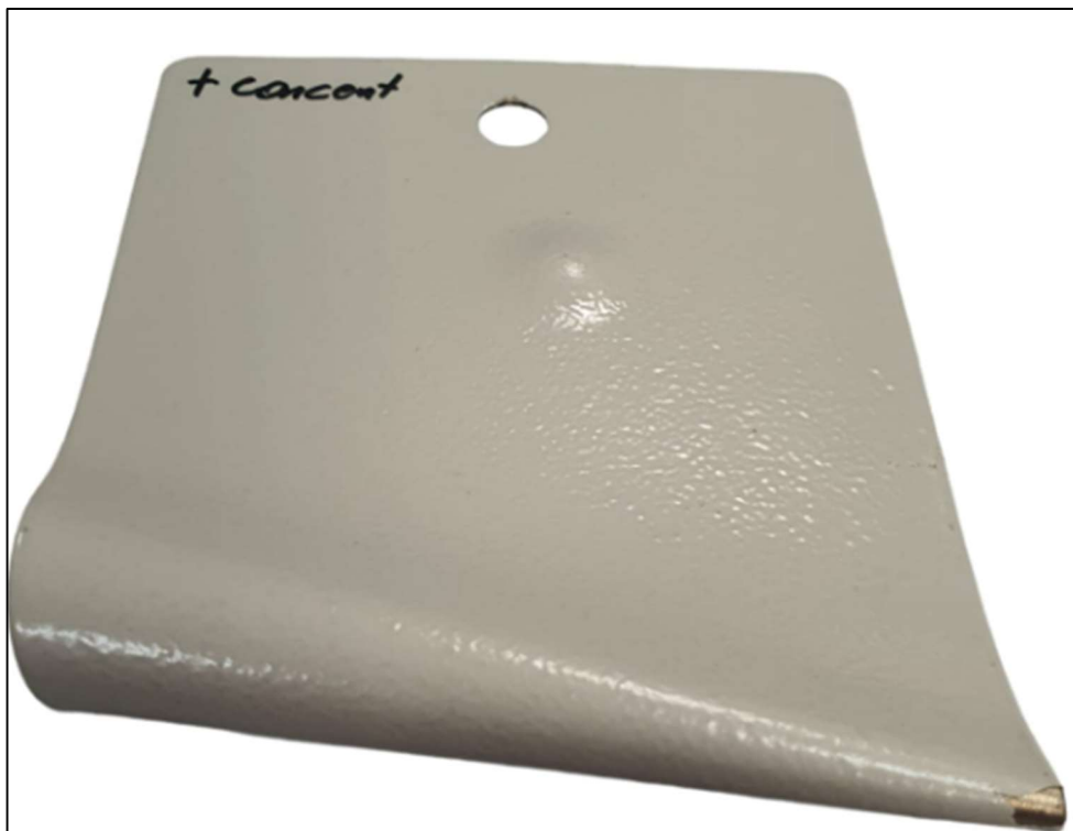
Figura 24 – Amostra reprovada alongamento
