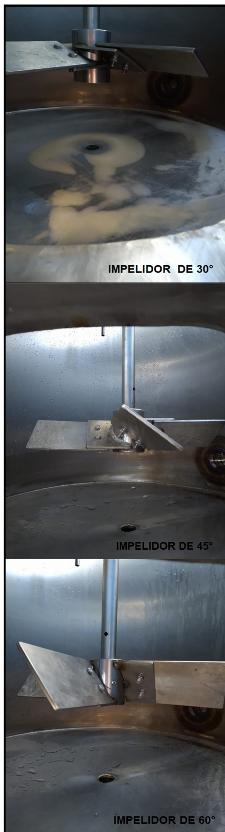
Figura 23: Comparativo de deposição de partículas no fundo do tanque
