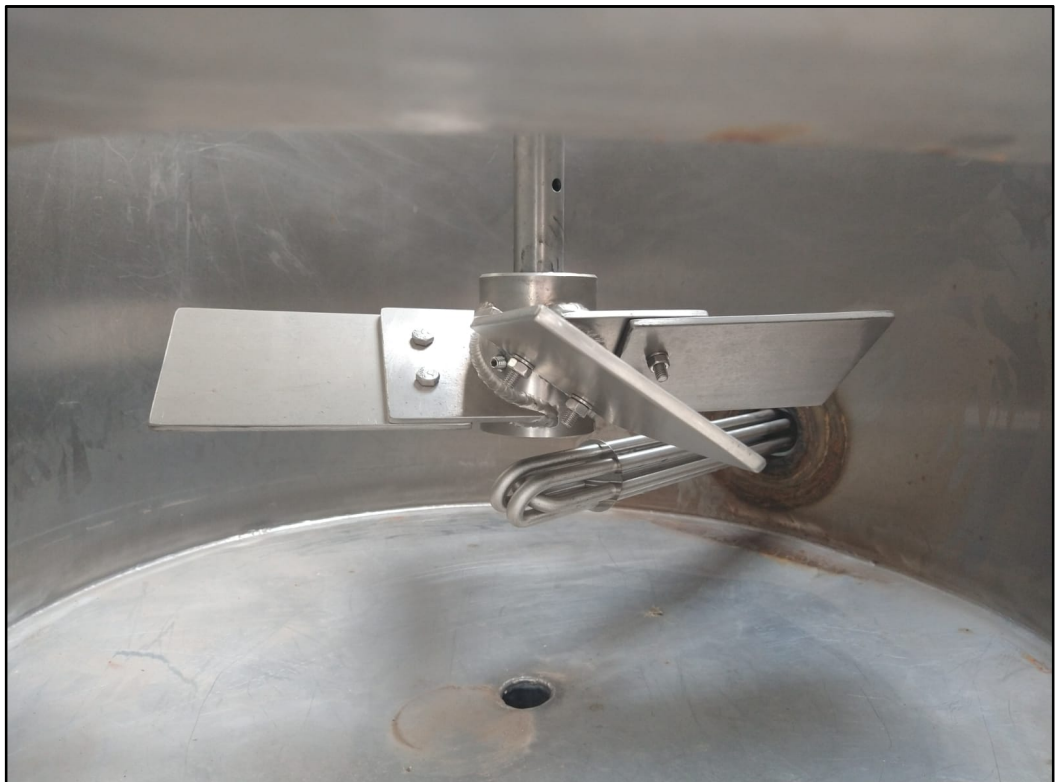
Figura 15: Impelidor de pás retas removível 45°
