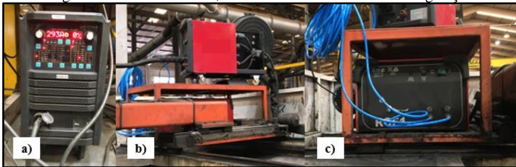
Figura 16 – Fonte de solda, trator de solda e unidade de refrigeração
