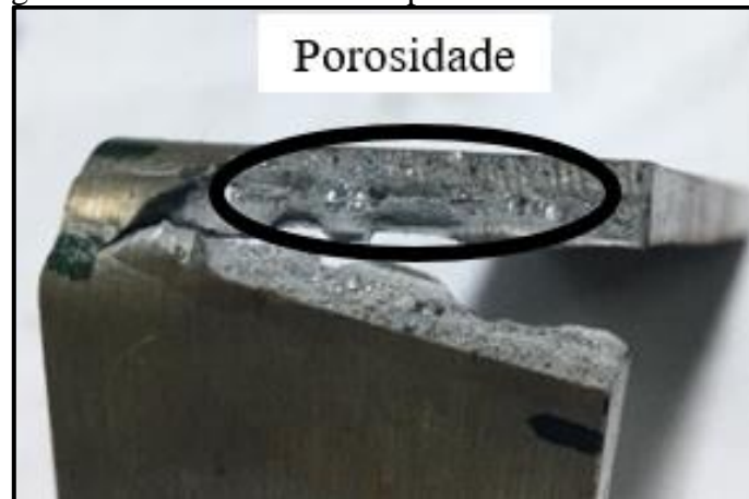
Figura 33 – Amostra com rompimento no cordão de solda
