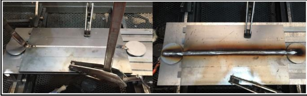
Figura 20 – Função do babeiro na soldagem dos corpos de prova
