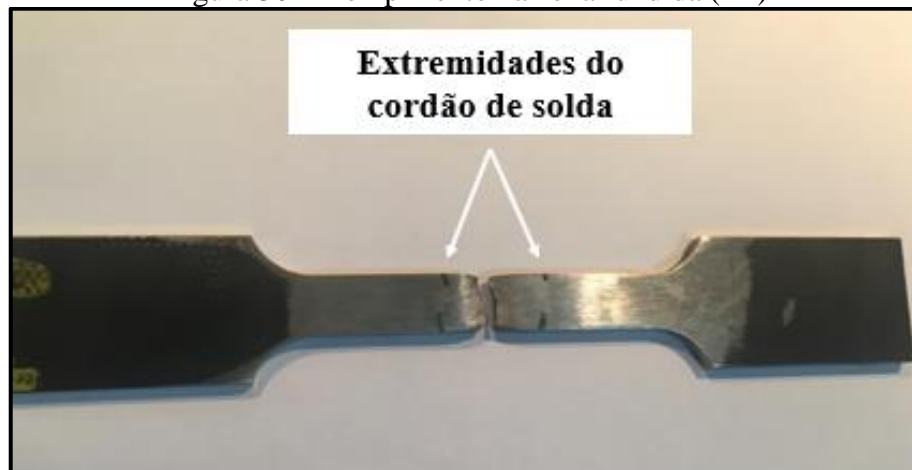
Figura 30 – Rompimento na zona fundida (ZF)
