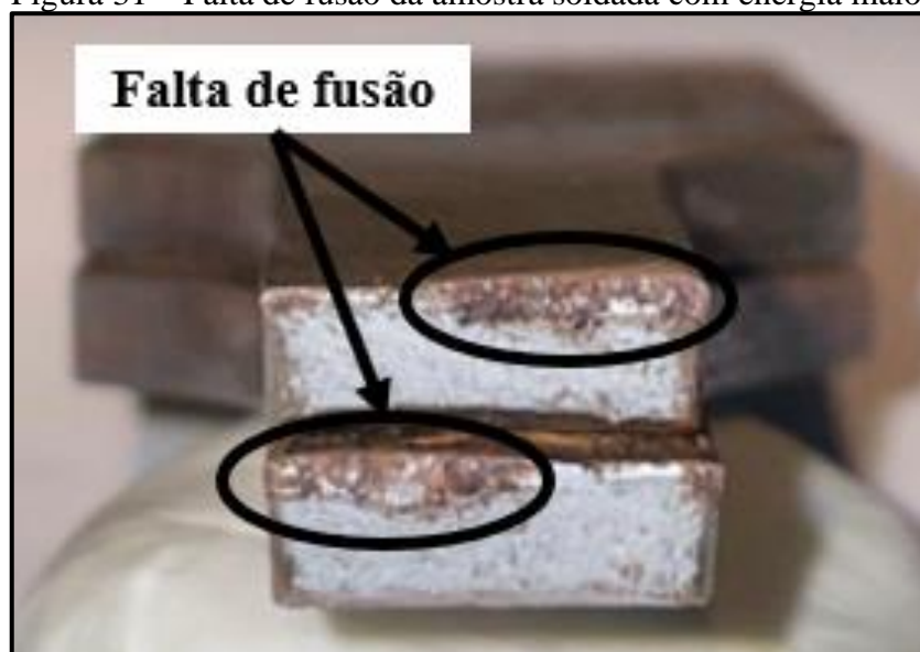
Figura 31 – Falta de fusão da amostra soldada com energia maior
