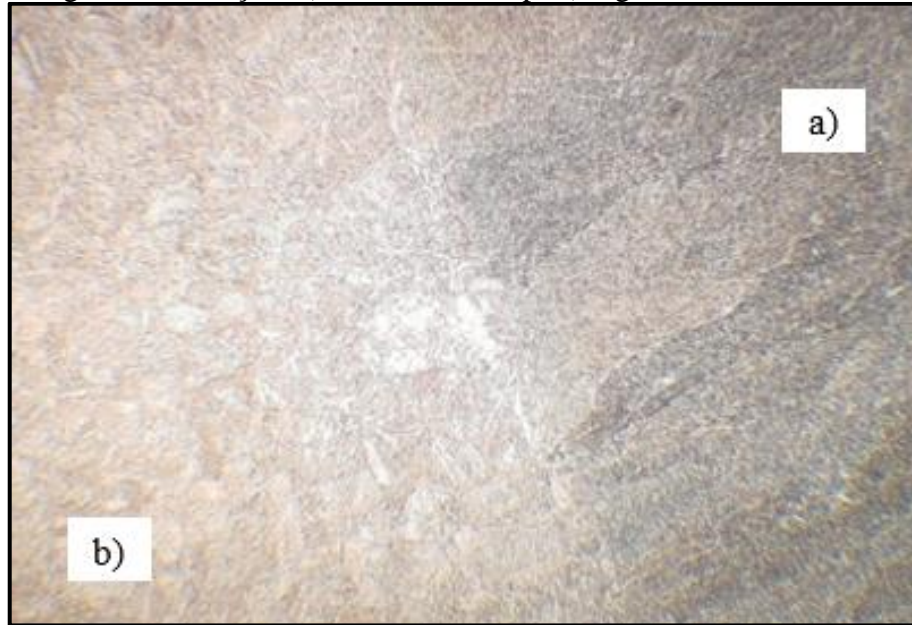
Figura 42 – Região de transição: a) metal de solda p/ b) região de crescimento de grão (50X)
