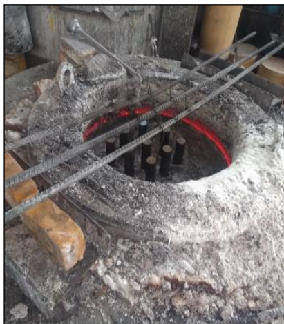
Figura 10 - Eixos testados no banho de sal
