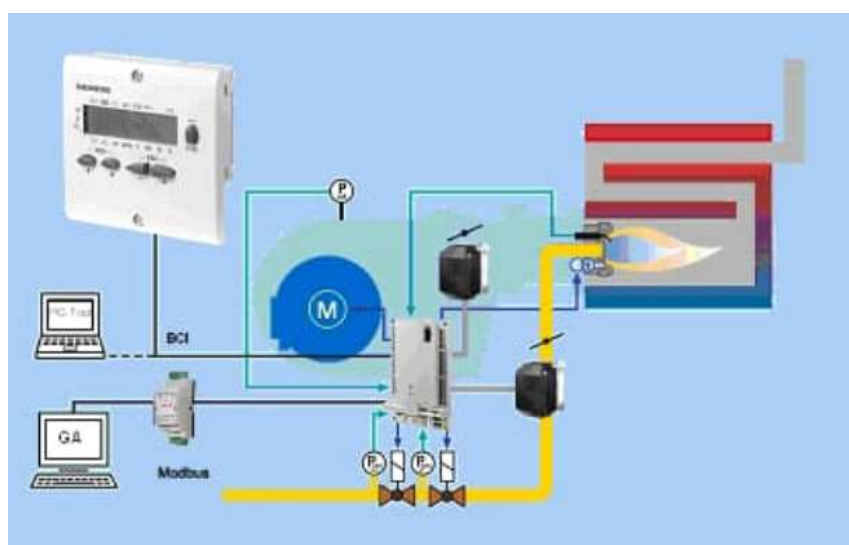
Figura 13 - Esquema de funcionamento do gerenciamento de combustão
