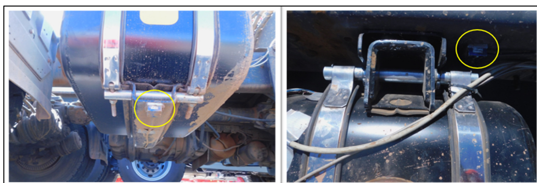
Figura 25 – Fixação dos acelerômetros na base do suporte e na longarina
