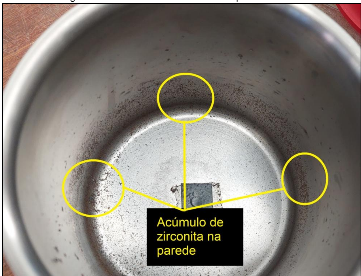
Figura 38 – Acúmulo de zirconita no recipiente metálico
