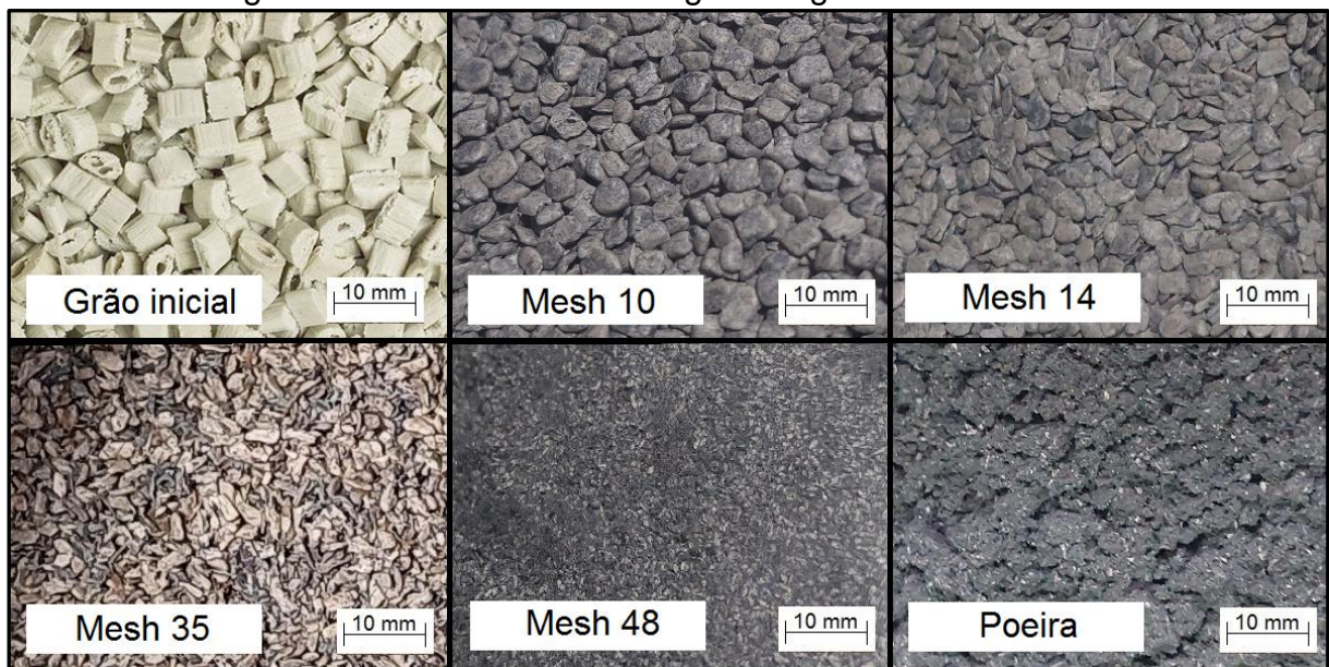
Figura 17 – Resultado da moagem do granulado de PA 66
