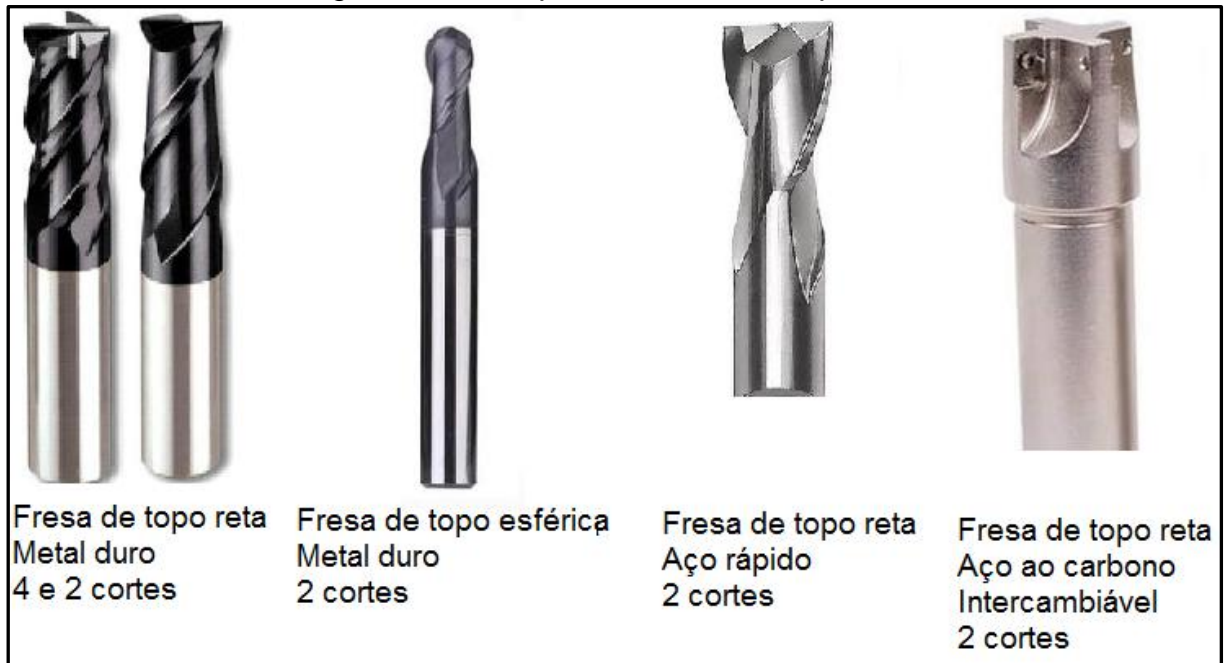
Figura 4 – Exemplos de fresas de topo reta
