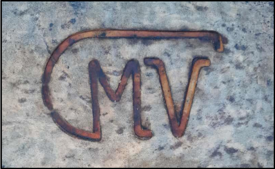
Figura 24 – Marcação a quente
