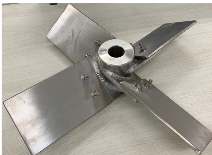
Figura 10 – Hélice de quatro pás inclinadas construída
