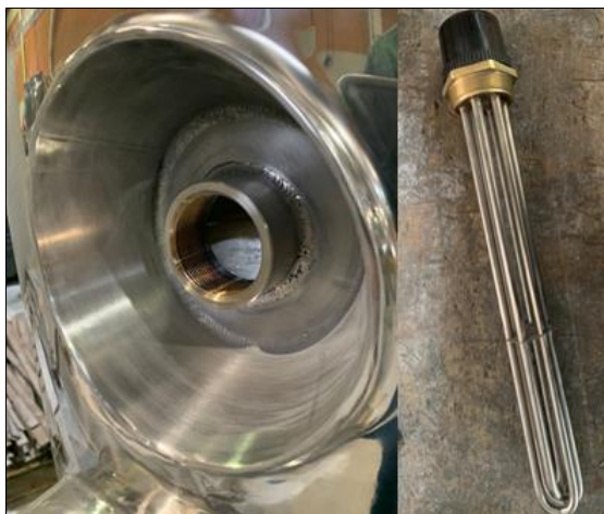
Figura 13 – Conexão com rosca (esquerda) e resistor elétrico (direita)
