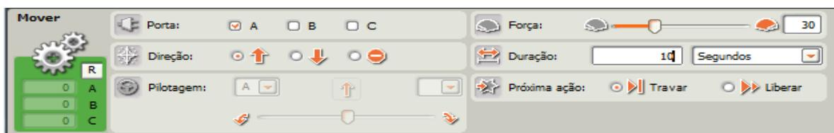
Todas as quatro equipes realizaram a montagem do robô 1 com 1 motor; rodas pequenas; rodas grandes. Este robô realiza o percurso em linha reta para trás como está selecionada a seta na descrição da figura 23. As equipes realizaram os testes com a regulagem 30. Para percorrer a distância de 4 metros, são gastos 10 segundos como pode ser visto na tabela 10, com o motor da porta A selecionado. A figura 23 descreve a programação do robô que andou para trás.
