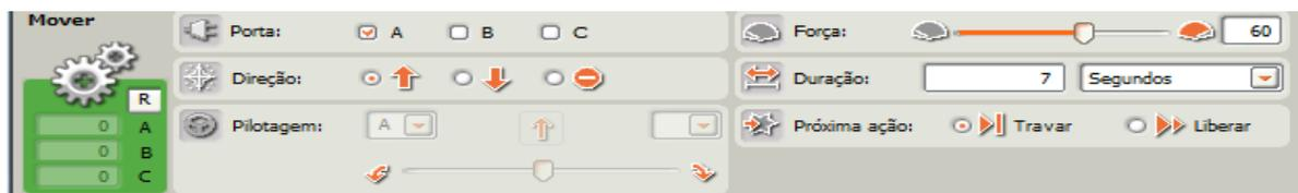
Todas as equipes realizaram a montagem do robô 1 com um motor com rodas pequenas e depois, com rodas grandes. Este robô realiza o percurso em linha reta para trás como está selecionada a seta na descrição da figura mover abaixo. As equipes realizaram os testes com a regulagem 100. Para percorrer a distância de 4 metros, precisa de 4 segundos e, para isso, foi selecionado o motor da porta A; força de regulagem. A figura 25 descreve a programação do robô ao andar para trás.
