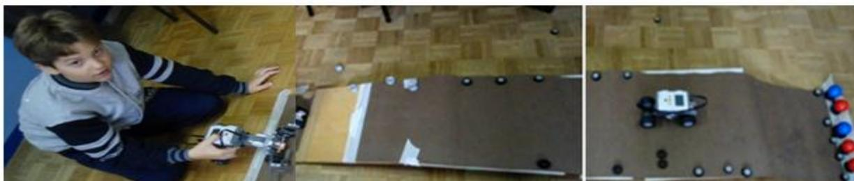
A figura 39 ilustra um estudante da equipe 2 testando dois robôs na rampa. Na figura, foram colocadas bolinhas azuis e vermelhas no final do percurso para simular obstáculos.
