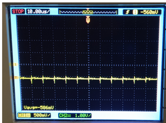
(a) Medição de V_{shunt} .
