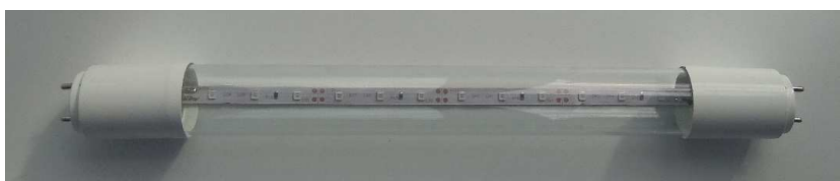
Figura 22 – Lâmpada LED UV num encapsulamento T8.
