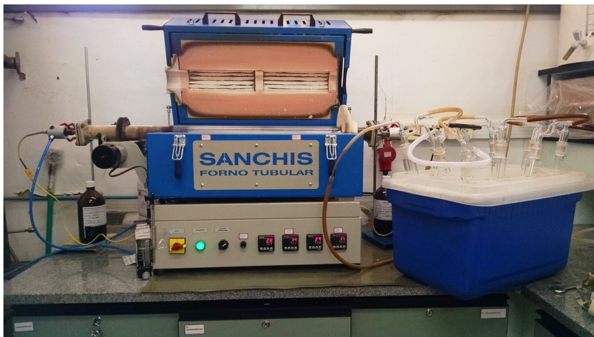
Figura 11. Reator pirolítico utilizado nos ensaios de pirólise.
