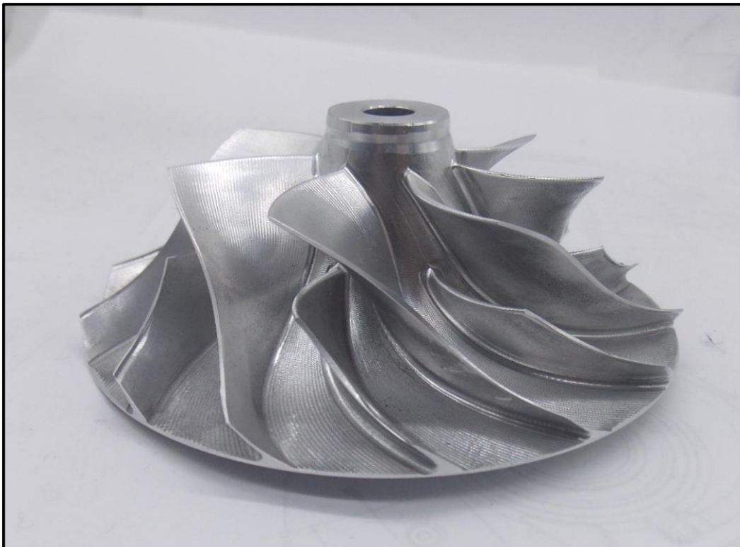
Figura 26 - Protótipo do rotor após usinagem
