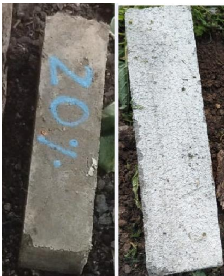
Figura 13 – Deficiência no tempo de cura dos corpos de prova com 20% de ZnO
