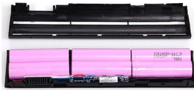
Figura 3 - Bateria de notebook da marca Dell aberta – células 18650 da marca Samsung
