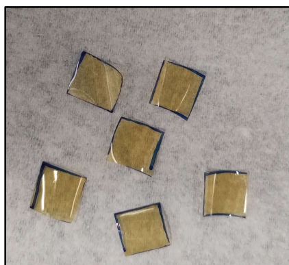
Figura 6 – Filmes reticulados à base de PVA, recortados em quadrados de 1 cm 2 .
