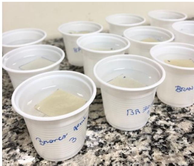
Figura 14 – Amostras dispostas em água para teste de solubilidade
