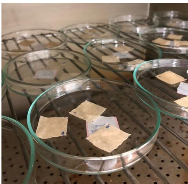
Figura 13 – Amostras em triplicata para teste de solubilidade em água
