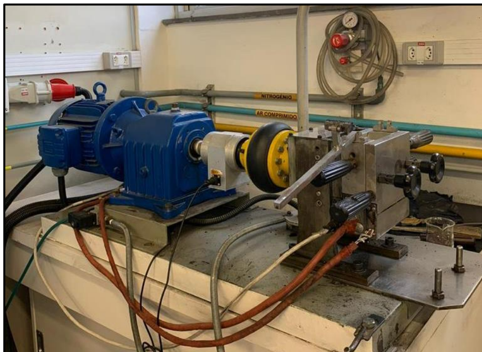
Figura 18 – Misturador interno acoplado a um reômetro de torque do tipo Haake
