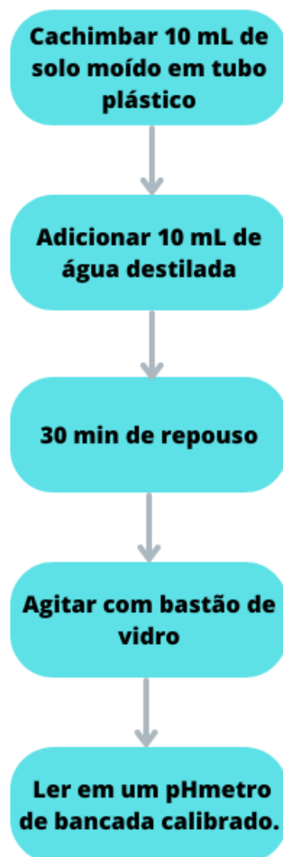
Figura 18 – Procedimento experimental para a determinação de pH
