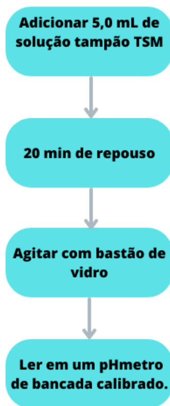
Figura 19 – Procedimento experimental para a determinação de SMP
