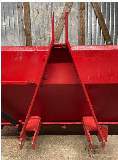
Figura 14 - Vista frontal do sistema de conexão do implemento no trator.
