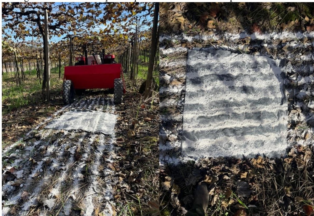
Figura 24 - Demonstração da quantidade de calcário depositada sobre a lona.
