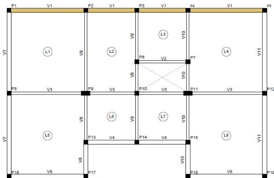
Figura 23 - Localização da Viga 1 Pavimento Térreo
