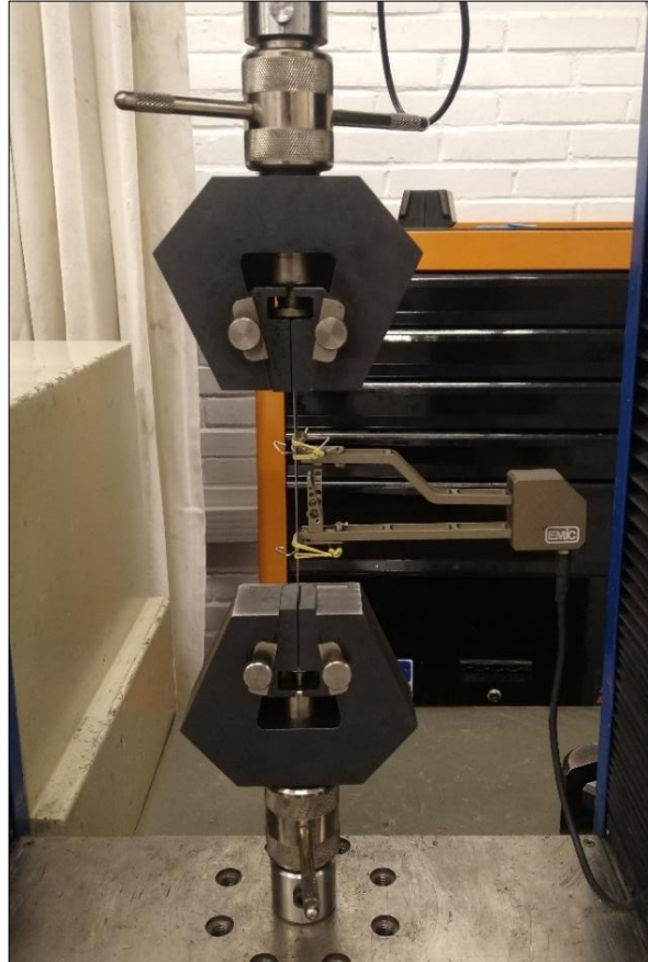
Figura 18- Execução do ensaio de tração
