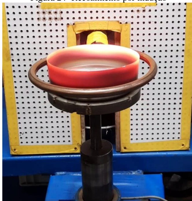
Figura 24- Recozimento por indução
