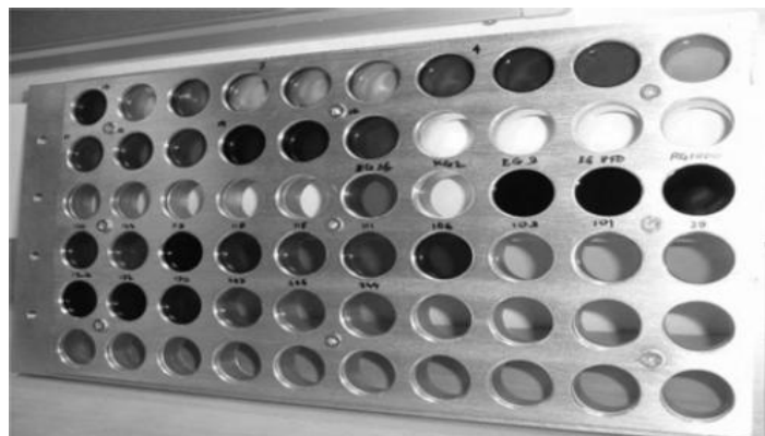
Figura 21: Filtros policromáticos utilizados para a determinação da resposta espectral proposta.
