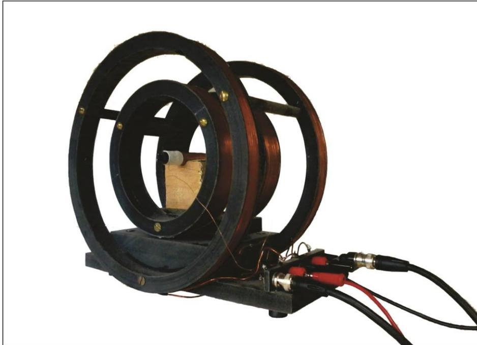
Figura 22: Conjunto de dois pares de diâmetros diferentes de bobina de Helmholtz, em arranjo concêntrico
