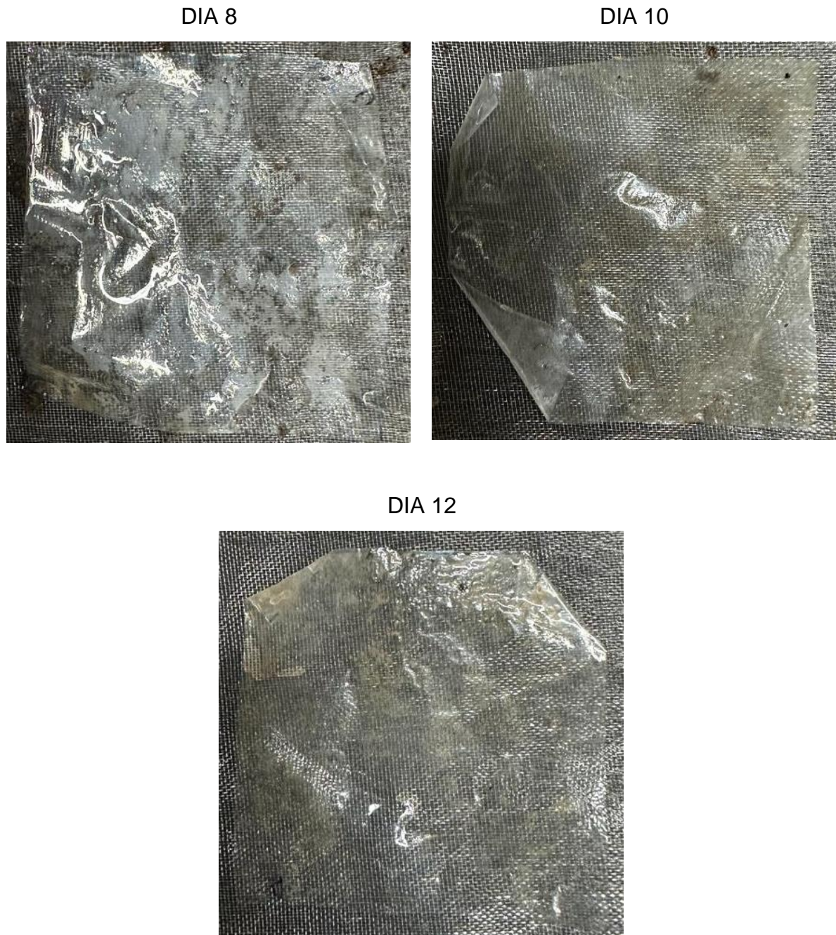
Figura 30 - Evolução da degradabilidade das amostras de membrana 8% PLA pelo período de 12 dias em solo simulado – intervalo de 8 a 12 dias
