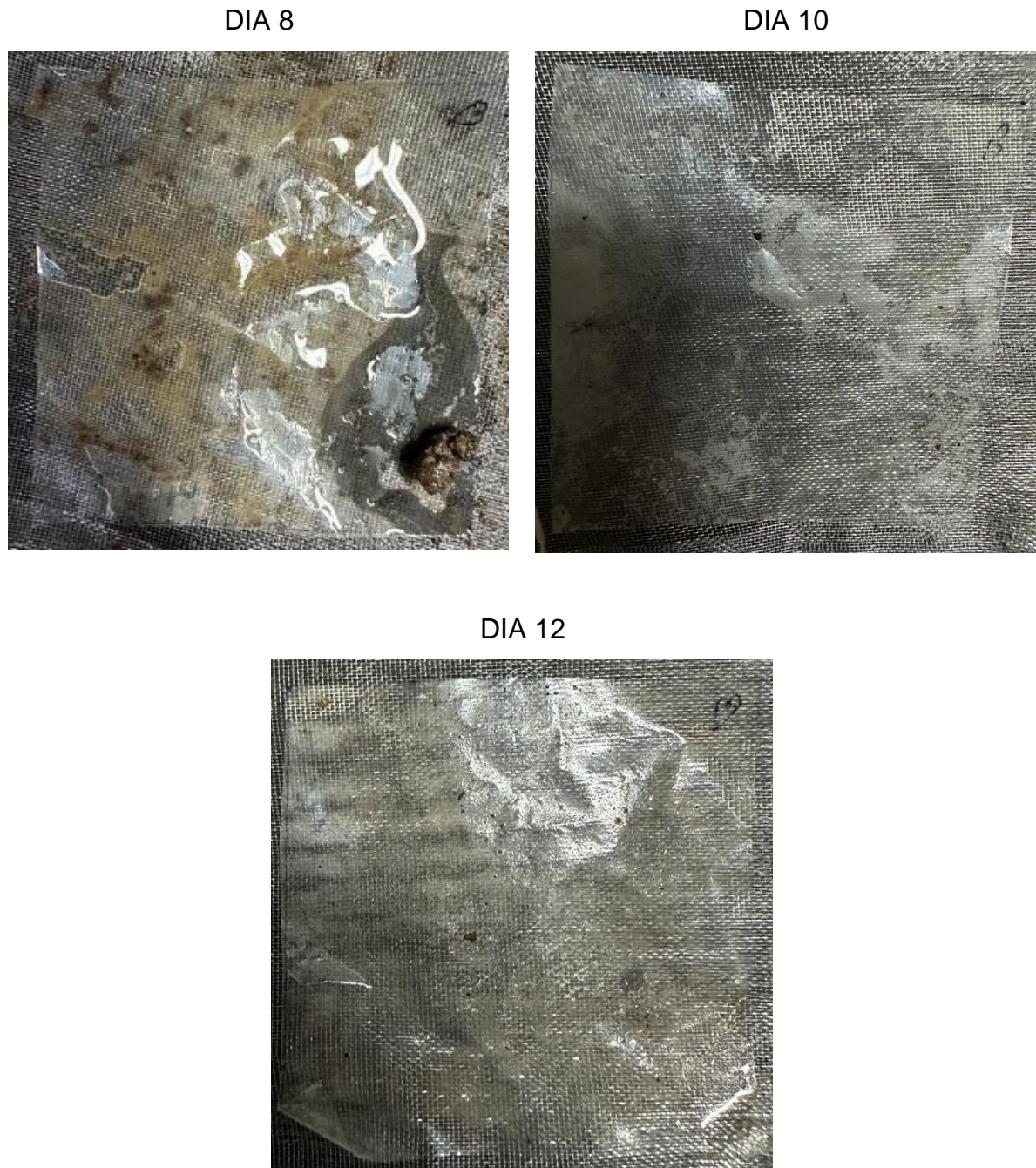
Figura 34 - Evolução da degradabilidade das amostras de membrana 8% PLA pelo período de 12 dias em solo urbano – intervalo de 8 a 12 dias
