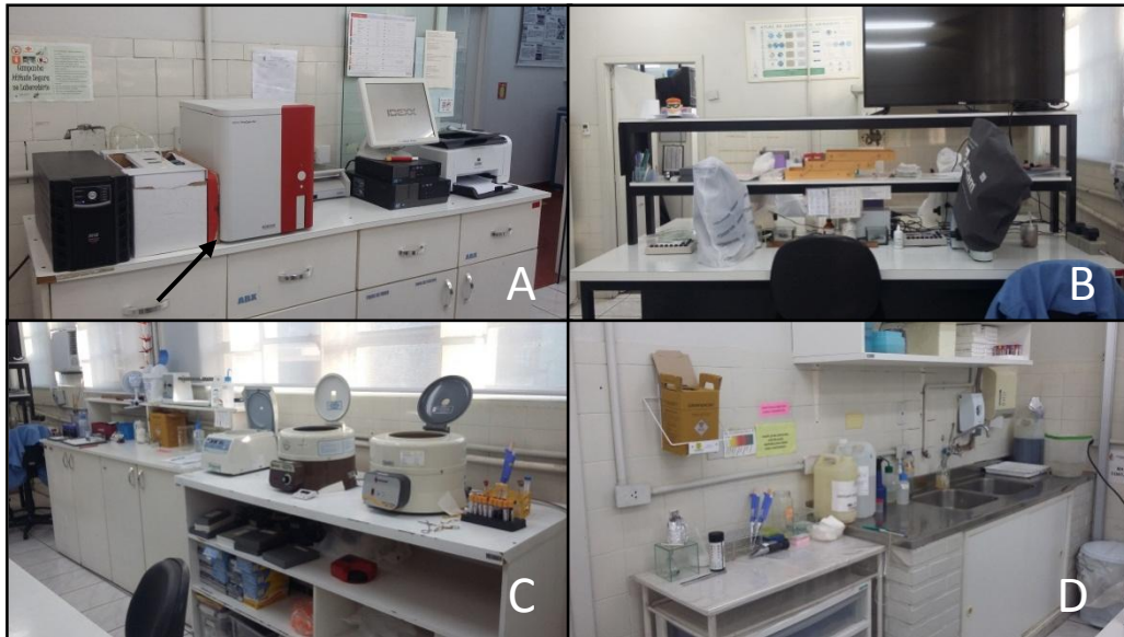
Figura 2 - Estrutura do Laboratório de Hematologia do Laboratório de Análises Clínica Veterinárias da UFRGS. A) Analisador (seta) de citometria de fluxo. B) Bancada para análise de microscopia. C) Centrifugas para microhematócrito, soro, plasma e urina. D) Local para realização da urinálise.
