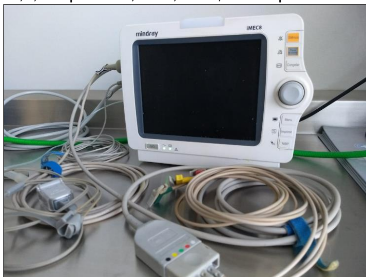
Figura 2 - Monitor multiparamétrico, parâmetros aferidos: ECG, FC, SpO 2 %, ETCO 2 , FiCO 2 , f, temperatura, PAS, PAM, PAD e pressão invasiva
