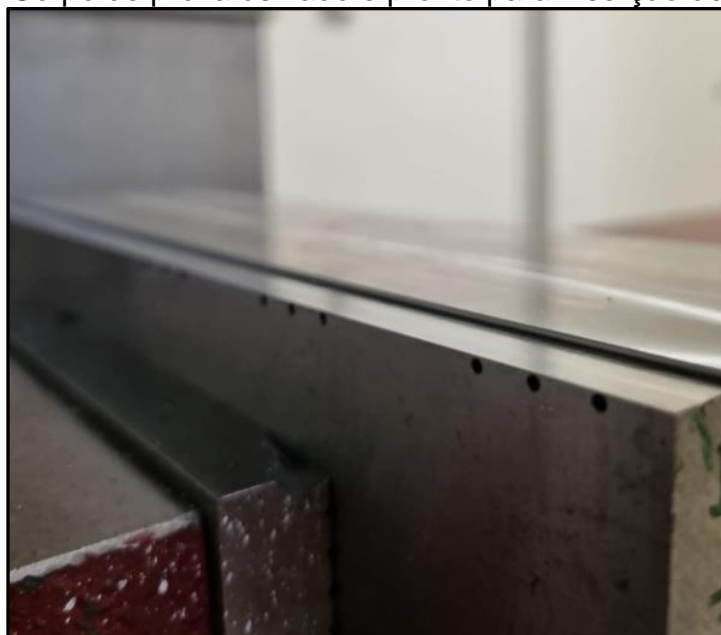
Figura 36 – Corpo de prova usinado e pronto para inserção de termopares
