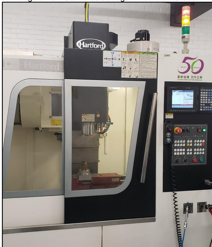
Figura 23 – Centro de usinagem Hartford LG-500
