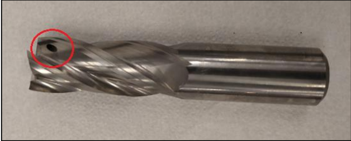
Figura 40 – Fresa sem tratamento preparada para inserção de termopares
