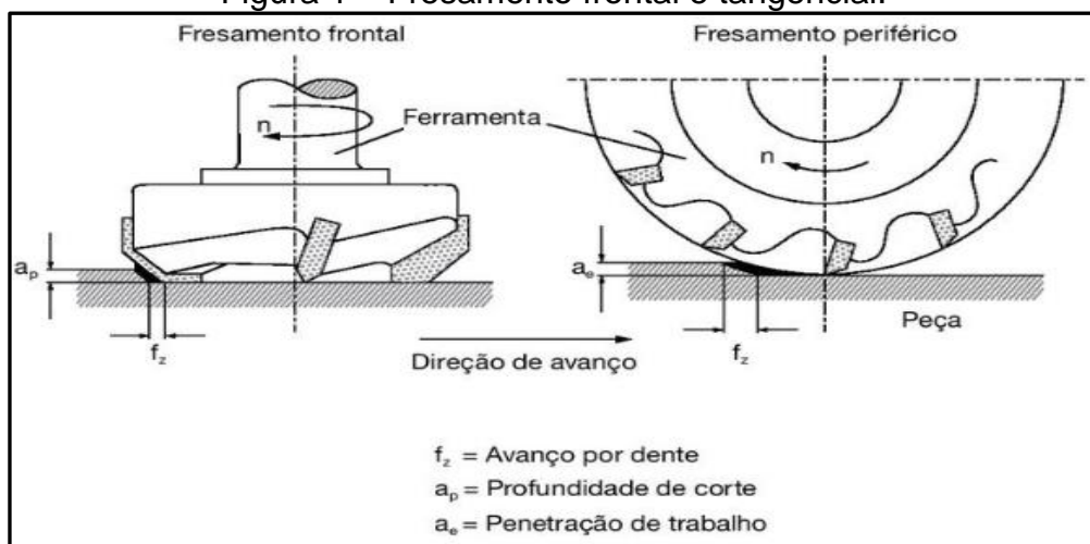
Figura 1 – Fresamento frontal e tangencial.
