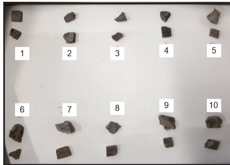
Figura 22 – Amostras dos concretos preparadas para análise por MEV.
