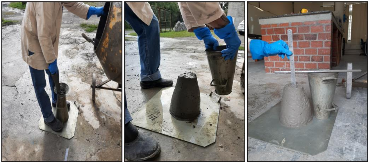
Figura 18 – Slump test : (a) enchimento do molde com concreto fresco (b) remoção do molde (c) medição do abatimento do concreto fresco.
