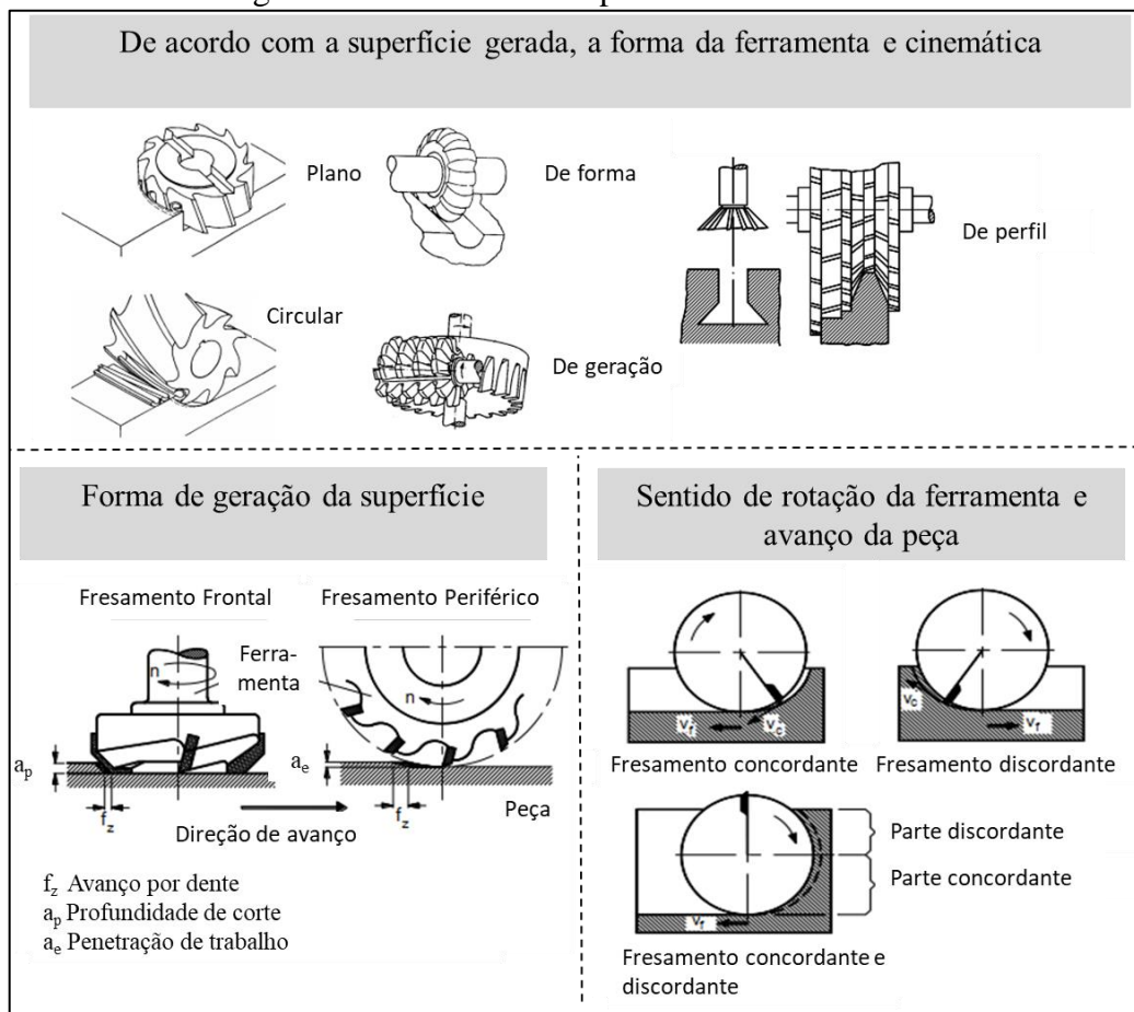
Figura 1 – Subdivisões do processo de fresamento
