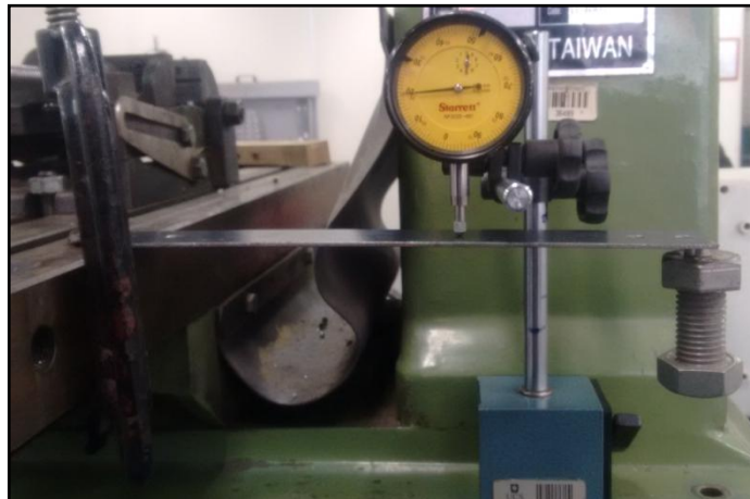
Figura C.1 – Medida da deflexão do apoio do mancal.
