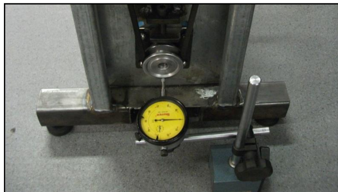
Figura 18 – Alinhamento da polia do motor.
