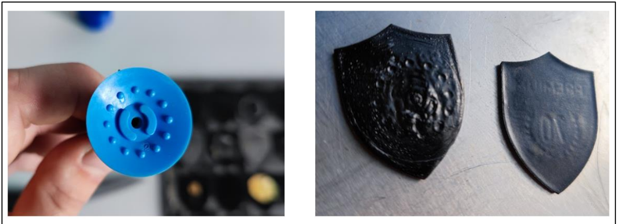
Figura 14: Deformação superficial do PVC a temperaturas acima de 60 °C
