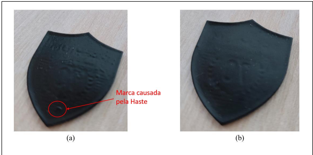
Figura 19: Método atual de remoção (a) em comparação com o uso da ventosa (b)
