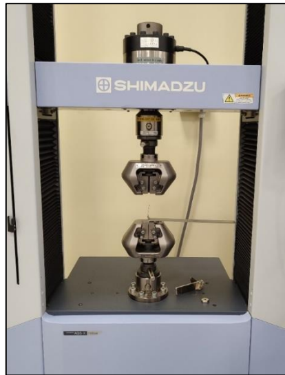
Figura 14- Máquina Shimadzu, modelo AGS-X utilizada no ensaio de descolamento.
