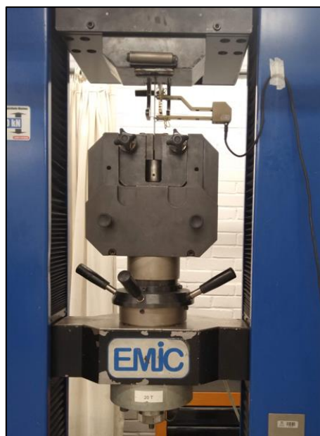
Figura 12- Máquina EMIC Modelo DL 20000, utilizada no ensaio de tração e anisotropia.
