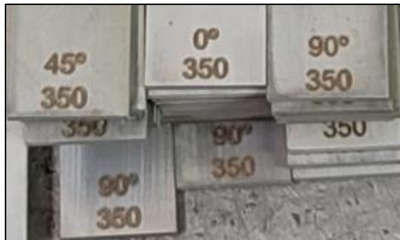
Figura 9- Gravações a laser da temperatura do tratamento térmico e direção da retirada das amostras em relação ao sentido de laminação.
