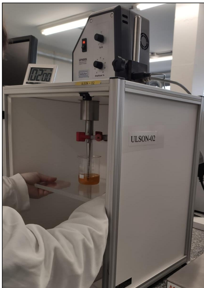
Figura 17 – Inserção do Becker no misturador ultrassônico
