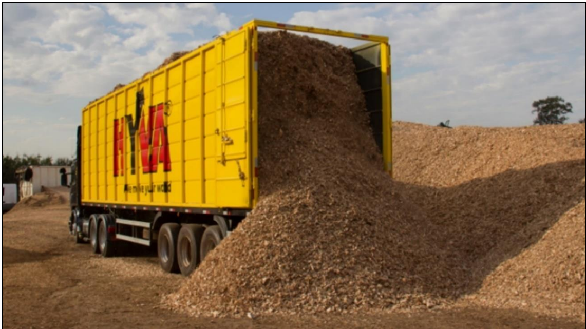
Figura 10 - Piso móvel HYVA realizando descarregamento de feno
