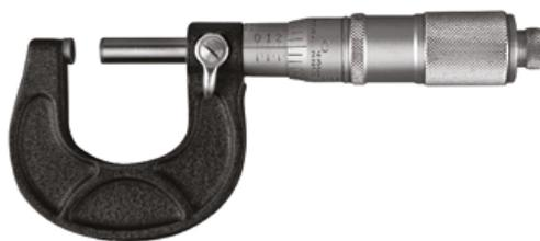
O micrômetro é usado para medir espessura, altura, profundidade, etc. de peças pequenas. Alguns têm graduação de 0,001 mm.
