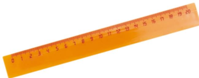
A régua é dividida em centímetros e milímetros e, em geral, seu comprimento varia entre 10 cm e 40 cm.
