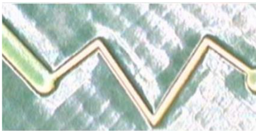
Figura 25: Trilha fusível em zigue-zague
