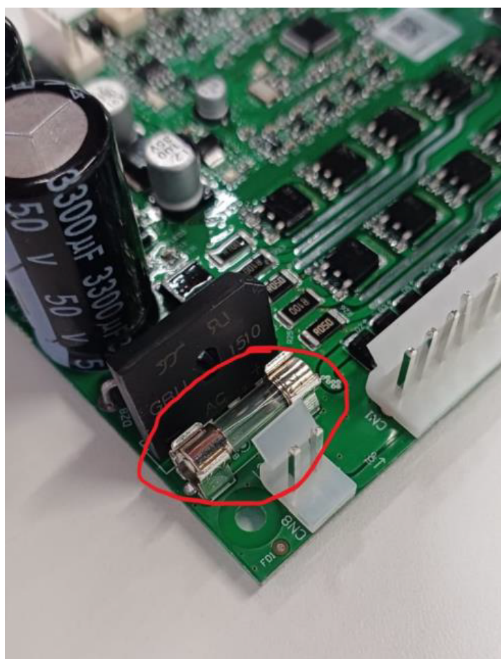
Figura 24: Fusível de vidro em um circuito eletrônico
