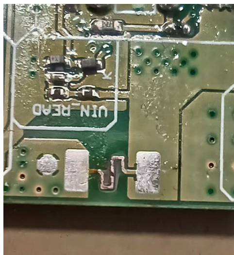
Figura 49: Danos ocasionadas na PCI pela atuação da proteção
