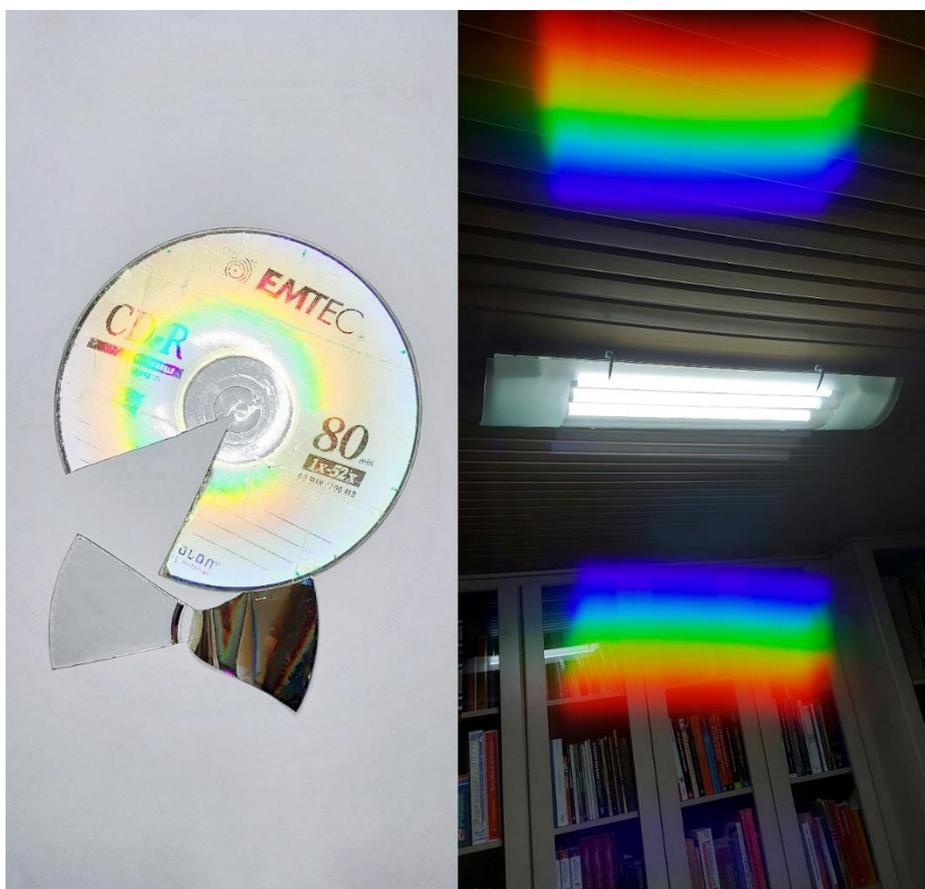
Figura 11. À esquerda, um CD, com sua etiqueta recoberta por fita adesiva larga, tem um pedaço recortado, por meio de uma tesoura grande. A película (etiqueta) sai junto da fita adesiva, com facilidade, como pode ser visto na imagem. A imagem à direita foi obtida com o pedaço de CD recortado, com sua etiqueta retirada, colocado em frente à lente da câmera de um telefone celular.
