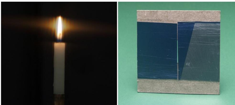
Figura 9 – A imagem de uma vela, fotografada através de uma fenda de aproximadamente 0,4 mm de largura (à esquerda). A fenda, recortada a partir de uma lata de refrigerante, aparece à direita). Note que é como se a imagem, contra intuitivamente, ficasse mais larga ao ser observada através de uma fenda estreita<sup>1</sup>.
