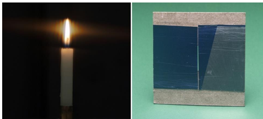
Figura P10 – A imagem de uma vela, fotografada através de uma fenda de aproximadamente 0,4 mm de largura, à esquerda. Note que é como se a imagem, contraintuitivamente, ficasse mais larga ao ser observada através de uma fenda estreita 1 .
