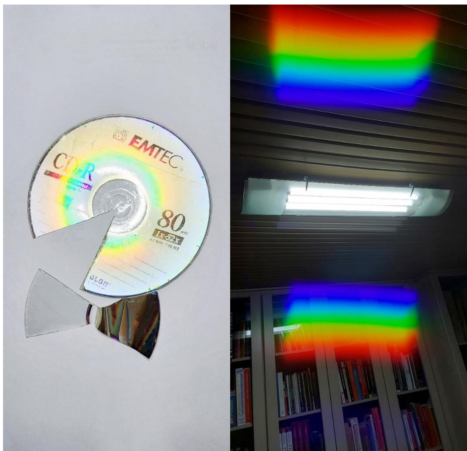
Figura P12. À esquerda, um CD, com sua etiqueta recoberta por fita adesiva larga, tem um pedaço recortado, por meio de uma tesoura grande. A película (etiqueta) sai junto da fita adesiva, com facilidade, como pode ser visto na imagem. A imagem à direita foi obtida com o pedaço de CD recortado, com sua etiqueta retirada, colocado em frente à lente da câmara de um telefone celular.
