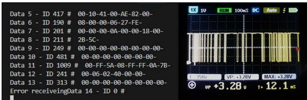
Figura 33 – Respostas da ECU no monitor da IDE e o sinal coletado no osciloscópio
