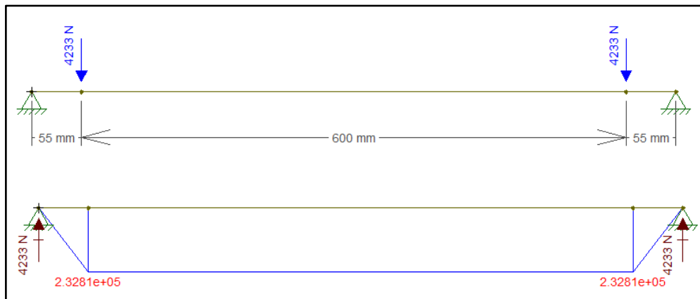
Figura 35 – Diagrama de momento fletor
