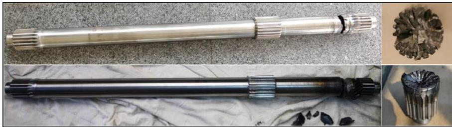
Figura 10 - Característica de fratura do eixo de transmissão
