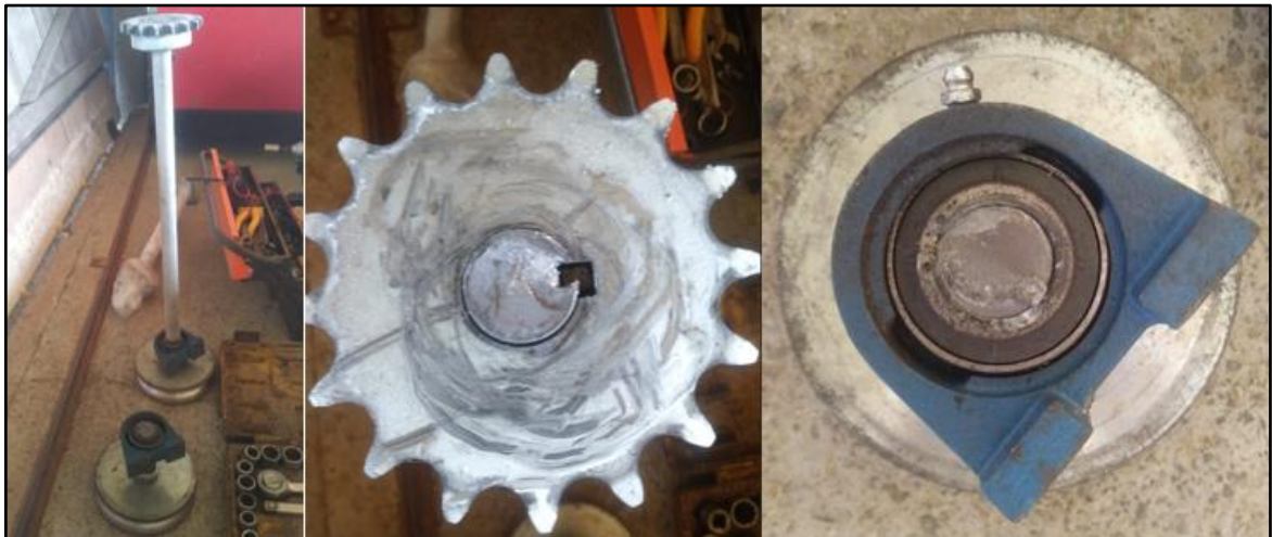
Figura 16 – Exemplo de quebra de eixo da tração no canal do anel
