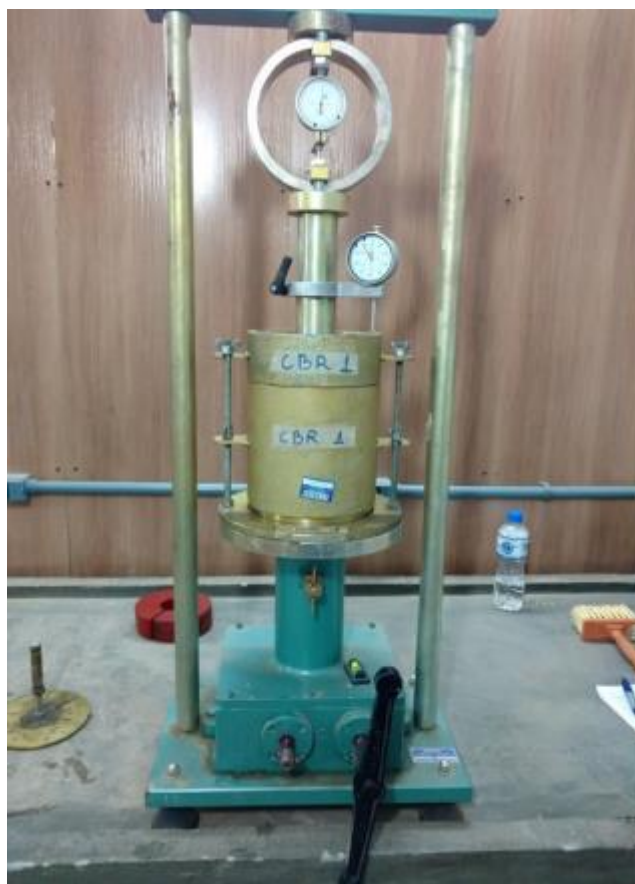
Figura 18 - Rompimento do corpo de prova na prensa manual Marshall/CBR
