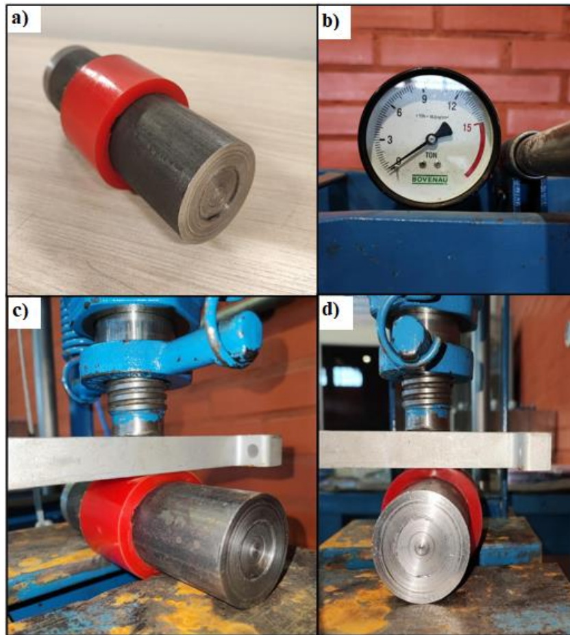
Figura 34 – Teste com polia de poliuretano
