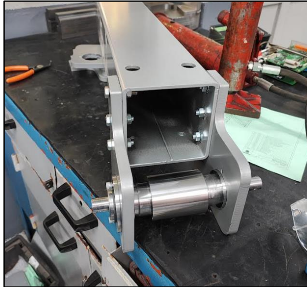
Figura 35 – Eixo com bucha de aço-carbono SAE 1020 com superfície lisa
