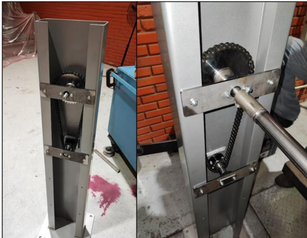
Figura 37 – Montagem do protótipo da torre de controle
