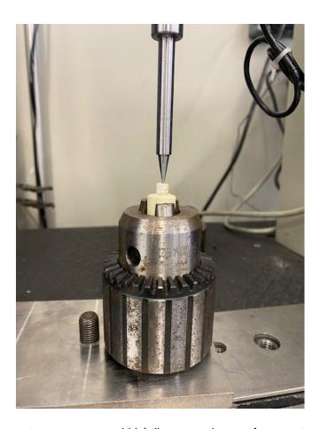
Figura 1: Detalhe da montagem na prensa hidráulica manual com a ferramenta utilizada para gerar a fratura radicular.
