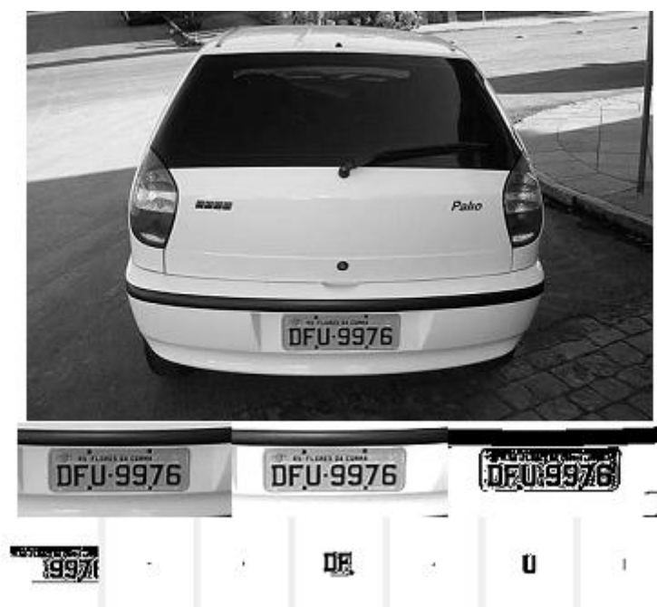
Figura 42: Falha ao segmentar os caracteres devido ao pouco contraste entre a placa e o fundo
