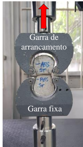
Figura 29. Execução do ensaio de arrancamento.
